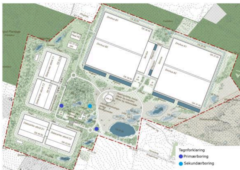
Figur 2 Masterplan maj 2025 visende datacenter, bassiner, drivhuse, interne veje og placering af indvindingsboringer, fra ansøgning om indvindingstilladelse
